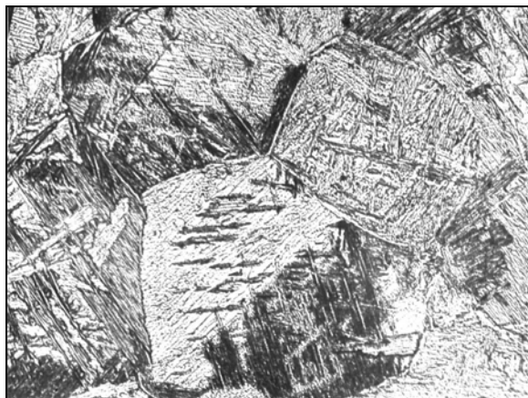
Рис.12. Микроструктура металла лопатки непосредственно под эродированной поверхностью в плоскости №1 (сплав ТС5) \times 1200
