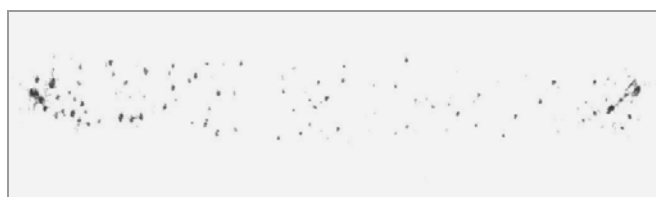
Рис. 8. Отпечаток с поверхности №1 лопатки, подвергнутой каплеударной эрозии ×30
